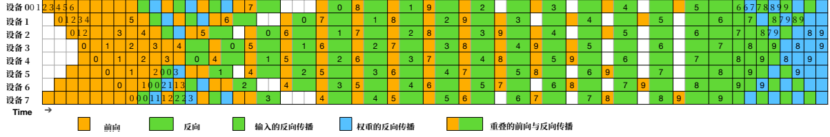
图 5 | 8 个 PP rank 和两个方向上 20 个微批次的 DualPipe 调度示例。反向方向的微批次与前向方向对称，因此为简化图示省略其批次 ID。由共享黑色边框包围的两个单元格表示计算与通信相互重叠。
